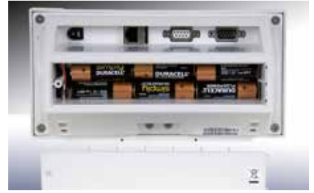
Compartiment batterie sur le D70E
